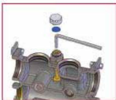
Aperto il Bypass presente su ciascun modulo, è possibile avere un collettore che fa anche da separatore idraulico. Soluzione molto comoda in presenza di più generatori di calore e/o circuiti primari.
